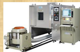
振動+恒温恒湿の複合試験も可能
